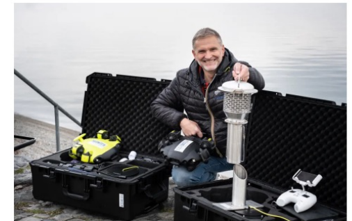
Erwin Rudolf mit der schwarzen Drohne, die in der Lage ist, in über 100 Metern Tiefe Seile an Schutzkörben zu befestigen.
